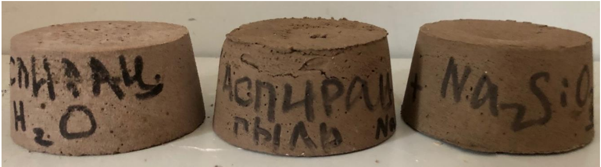
Рисунок 6.6 – Образцы из аспирационной пыли: затворение водой (слева); затворение \text{Na}_2\text{SiO}_3 и ускорителем твердения \text{Na}_2\text{SiF}_6 (по центру); затворение \text{Na}_2\text{SiO}_3 (справа)
