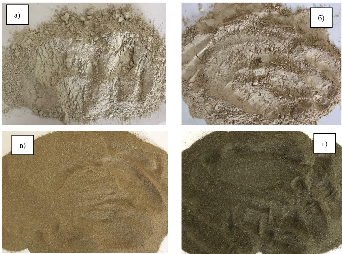
Рисунок 6.4 – Фотографии реакционноспособных минеральных порошков: а) окремненный мергель; б) термоактивированный окремненный мергель; в) аспирационная пыль; б) клинкерная пыль
