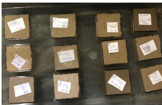
Рисунок 7.8 – Образцы СРЩА составов 1:1, 1:2, 1:3 в процессе водонасыщения и последующего взвешивания
