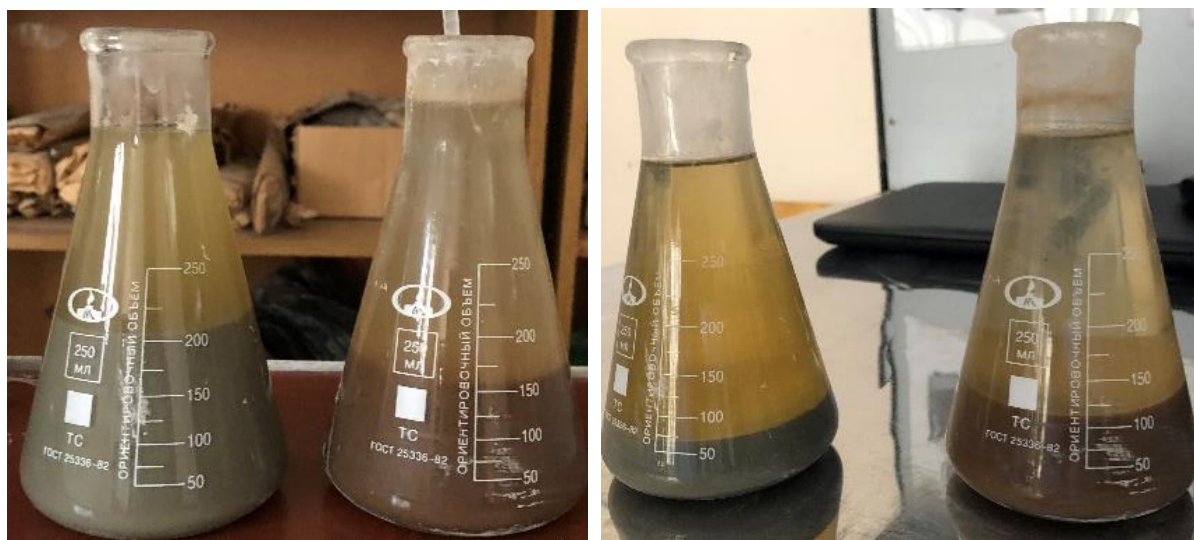
Рисунок 8.3 – Снимки щелочных растворов на основе кварцевого песка и вулканического туфа, через час (а) и через сутки (б); слева колба с щелочным раствором на кварцевых песках; справа с щелочным раствором на вулканическом туфе
