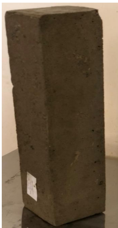
Рисунок 7.26 – Деформации бетонных призм на вяжущей связке «аспирационная порошок+ клинкерная порошок – барханный песок 25% – \text{Na}_2\text{SiO}_3 »
