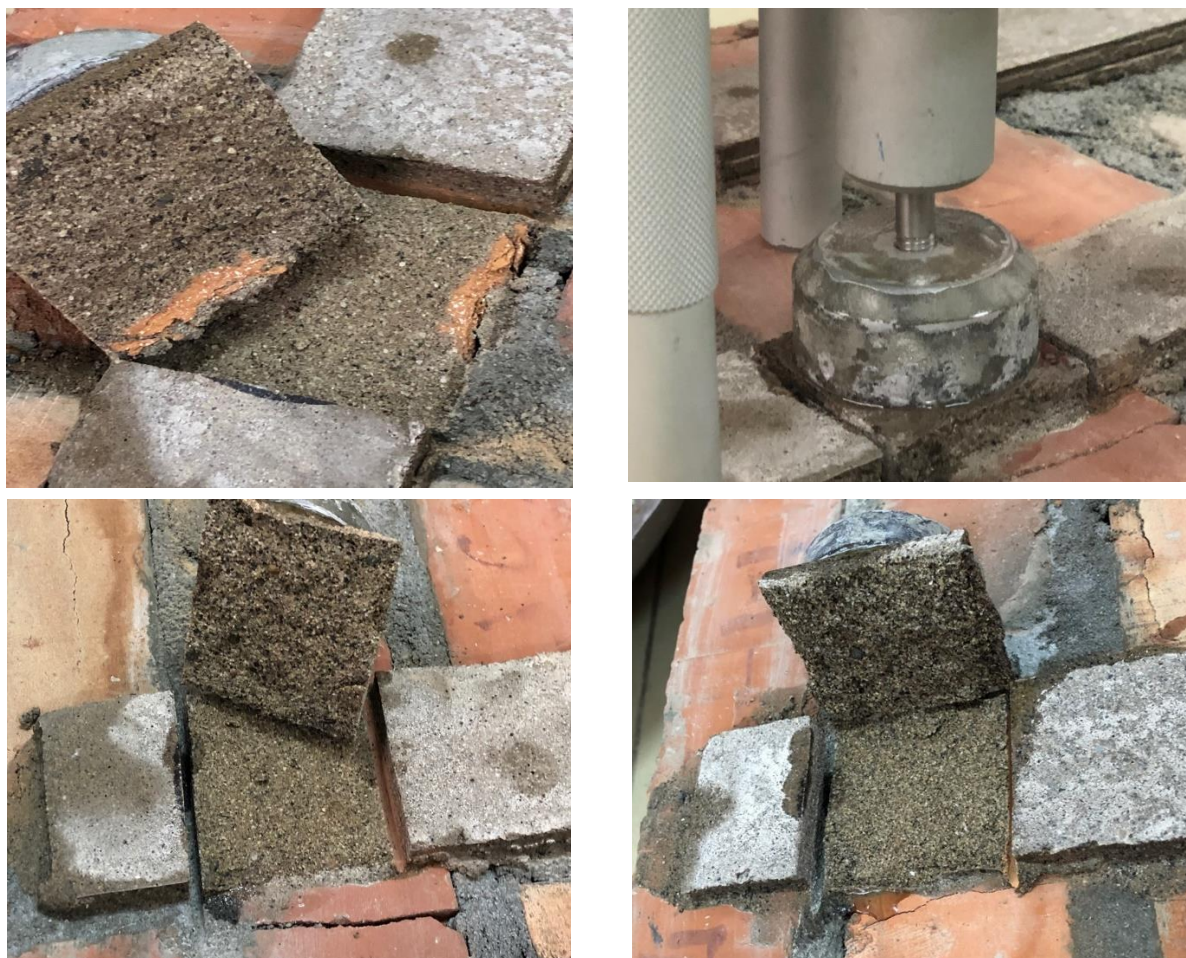
Рисунок 7.12 – Проведение испытаний на отрыв СРЩА от кирпичной стены
