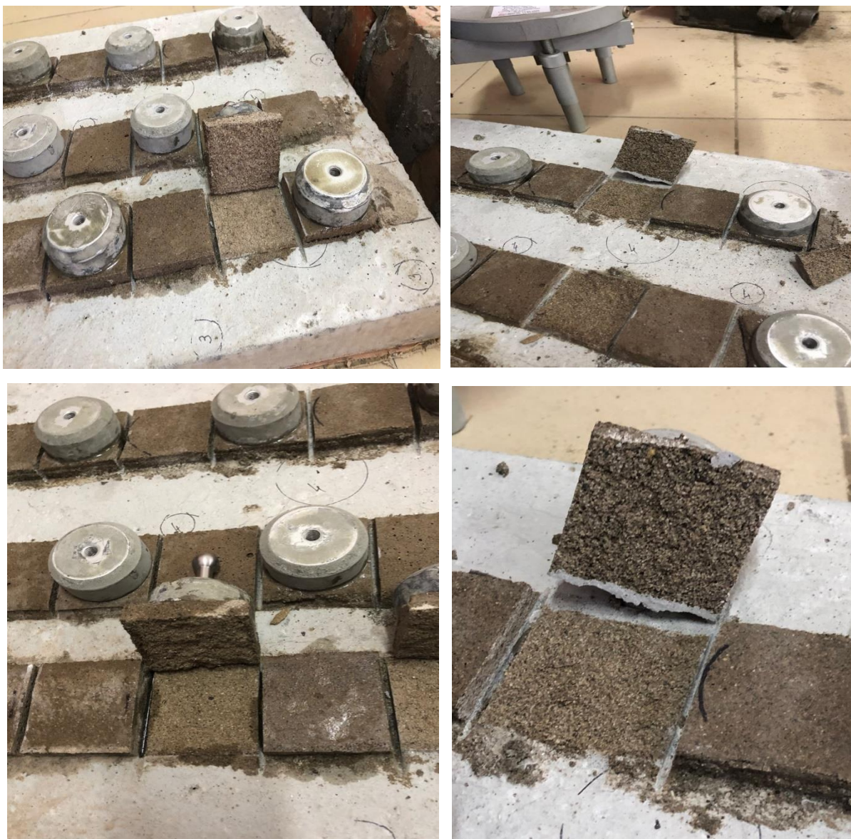
Рисунок 7.11 – Проведение испытаний на отрыв СРЩА от бетонного основания
