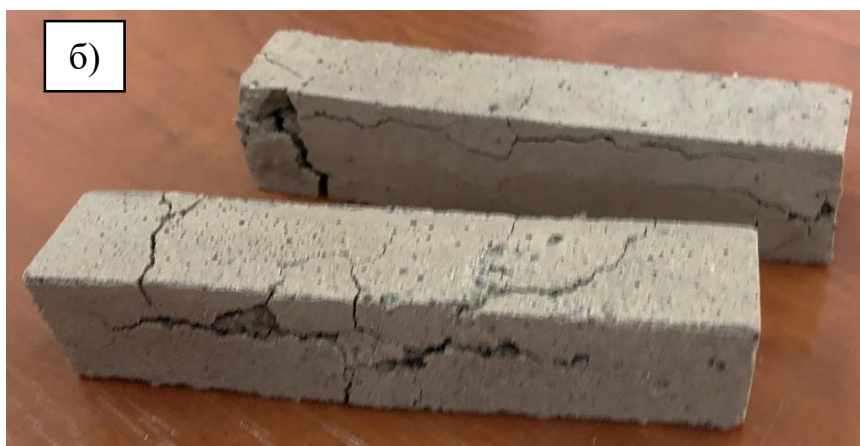
Рисунок 7.35 – Образцы бесклинкерных вяжущих щелочной активации после испытаний; а) на кислотостойкость; б) на щелочестойкость
