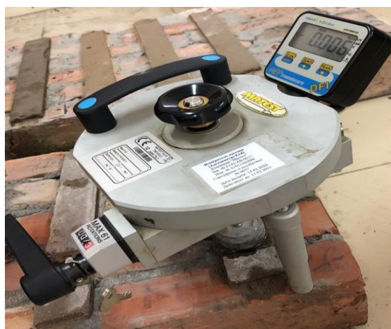
Рисунок 7.11 – Проведение испытаний на отрыв СРЩА от бетонного основания
