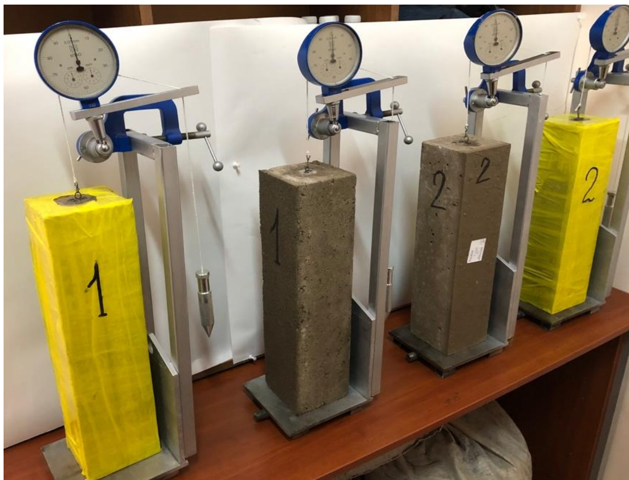
Рисунок 7.22 – Общий вид испытаний призм на усадочные деформации
