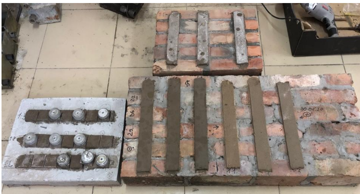
Рисунок 7.10 – Подготовка лабораторного стенда для проведения испытаний на адгезию; а – бетонная плита с образцами; б – кирпичная стена с образцами
