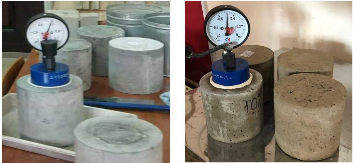
Рисунок 7.33 – Испытания на водонепроницаемость бетонных цилиндров на приборе ВВ–2
