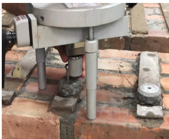
Рисунок 7.11 – Проведение испытаний на отрыв СРЩА от бетонного основания
