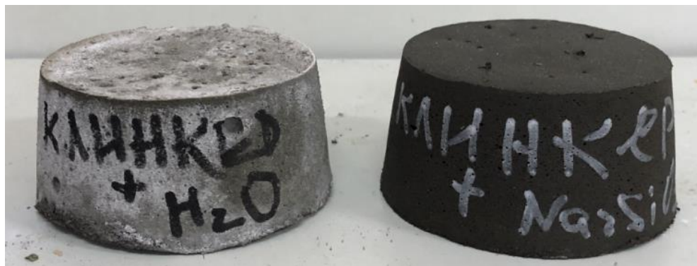
Рисунок 6.7 – Образцы из клинкерной пыли затворенной водой (слева) и метасиликатом натрия (справа)
