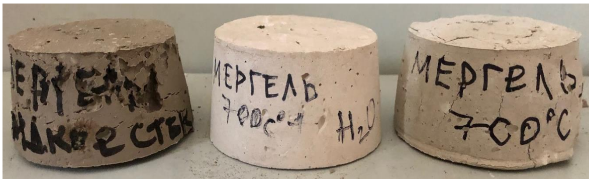
Рисунок 6.5 – Образцы из высокодисперсного мергеля: без термообработки затворение \text{Na}_2\text{SiO}_3 и ускорителем твердения \text{Na}_2\text{SiF}_6 (слева); термоактивированный 700 °С затворение водой (по центру); термоактивированный 700 °С затворение \text{Na}_2\text{SiO}_3 (справа)
