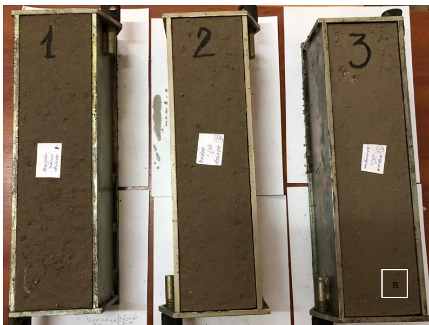
Рисунок 7.22 – Общий вид испытаний призм на усадочные деформации
