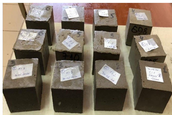
Рисунок 7.8 – Образцы СРЩА составов 1:1, 1:2, 1:3 в процессе водонасыщения и последующего взвешивания
